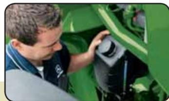
Резервуар для охлаждающей жидкости снабжен удобным смотровым окном для быстрой визуальной проверки. Широкая заправочная горловина позволяет заливать жидкость, как с воронкой, так и без воронки.
