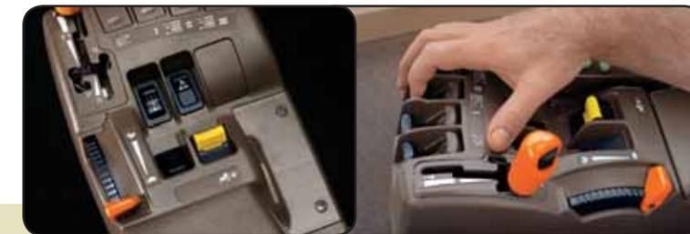
Органы управления BOM, секционным распределителем, функцией AutoTrac, тягой 3-точечной навески расположены на пульте CommandArm и просты в использовании.
