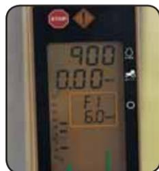
На новом усовершенствованном мониторе, установленном на угловой стойке, отображается частота вращения двигателя, передача, заданная скорость AutoPowr, скорость движения, уровень топлива, температура трансмиссионного масла/гидравлической рабочей жидкости, температура охлаждающей жидкости двигателя, статус ВОМ, системы управления орудиями IMS, автоматической коробки PowerShift и блокировки дифференциала.
