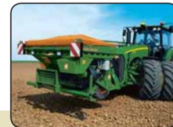
Высококачественная передняя навеска (опция) обладает большой грузоподъемностью для подъема, перемещения или транспортировки бункеров для семян или агрегатирования широкозахватных орудий для обработки почвы массой до 5200 кг.
