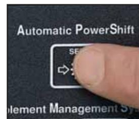
Чтобы выбрать оптимальную скорость во время полевых работ и при движении по дороге, автоматическая коробка передач PowerShift «Джон Дир» анализирует нагрузку двигателя, положение рычага топливной подачи 50 раз в секунду во время выполнения рабочих операций или при транспортировке оборудования и затем осуществляет выбор передачи.
