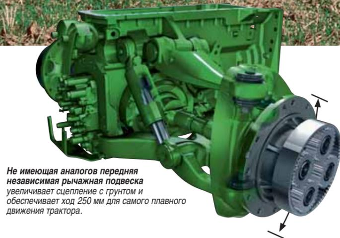
Не имеющая аналогов передняя независимая рычажная подвеска увеличивает сцепление с грунтом и обеспечивает ход 250 мм для самого плавного движения трактора.
