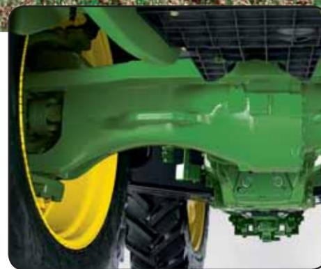
Новый усиленный передний мост с гидравлической блокировкой дифференциала устанавливается по заказу на заводе-изготовителе на всех колесных тракторах серии 8030. Кроме того, возможна установка сдвоенных передних колес для уменьшения уплотнения почвы.
