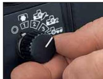
Селектор режима AutoPowr – выберите: **Положение 1** для работ с приводом от ВОМ **Положение 2** для работ со значительными тяговыми усилиями **Положение 3** уменьшает расход топлива на легких операциях обработки почвы, транспортировки или посева.
