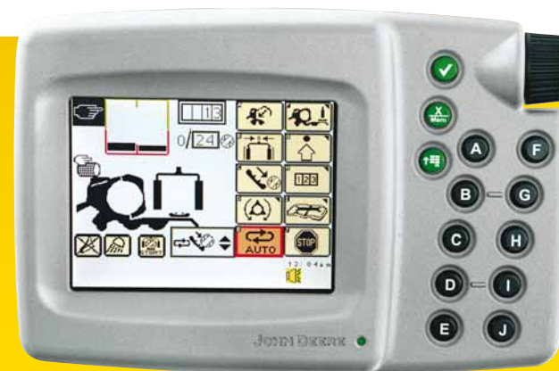
Благодаря сертификации ISOBUS большой цветной монитор VTi 1300, также как и все сертифицированные мониторы John Deere GreenStar, отражает все функции пресс-подборщика 744 – для этого достаточно одного взгляда на монитор.
