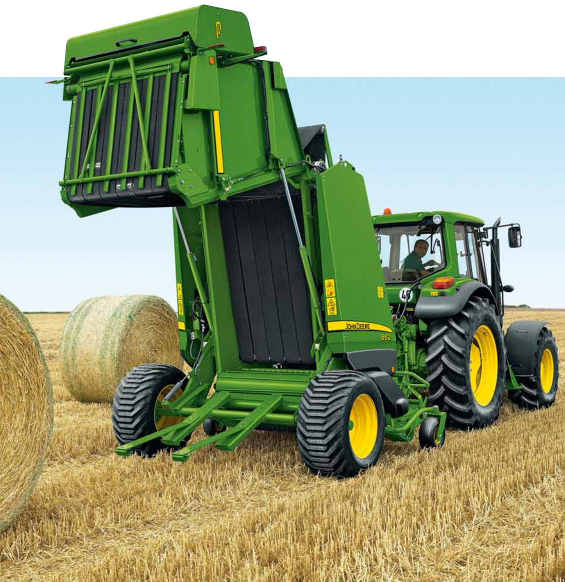
Рулонный пресс-подборщик модели 862 с камерой прессования переменного объёма. Наш самый большой пресс-подборщик с камерой прессования переменного объёма предназначен для тех, кто заготавливает большие рулоны. Оборудованный питателем HiFlow шириной 2,0 м, он идеально подходит для непрерывной высокопроизводительной работы.
