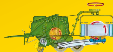
Пресс-подборщик модели 744 с системой транспортной платформы (TTSsystem) является рентабельной машиной для быстрого формирования рулонов силоса в одиночку.
