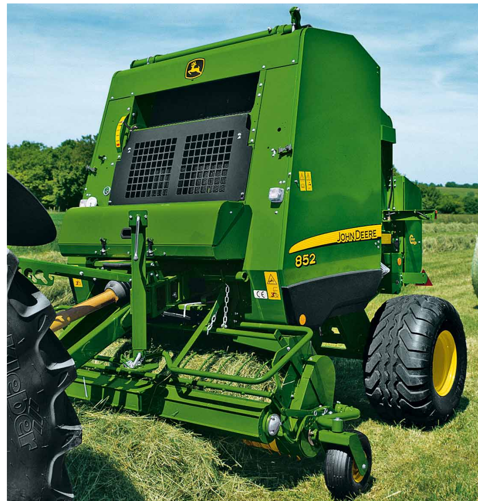
Рулонный пресс-подборщик модели 852 с камерой прессования переменного объёма. Эта лёгкая «рабочая лошадка» может оборудоваться либо стандартным питателем шириной 1,81 м, либо зубцовым питателем HiFlow шириной 2,0 м. Он с лёгкостью производит рулоны диаметром от 0,60 м до 1,55 м в течение всего рабочего дня.
