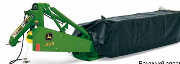
Режущий аппарат роторного типа
