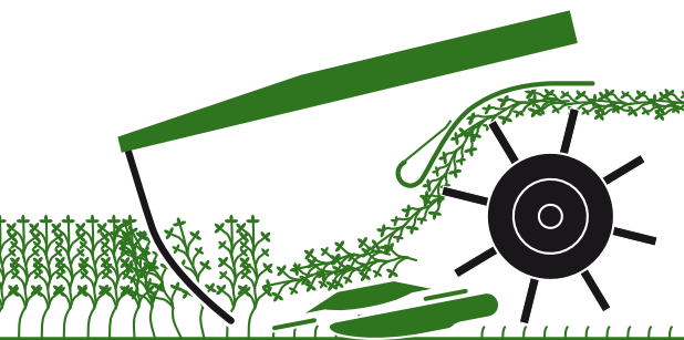
Принцип действия роторной плющилки
