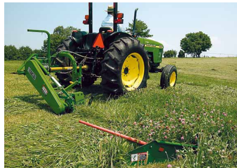
Режущий аппарат ножевого типа
