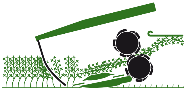
Принцип действия вальцовой плющилки
